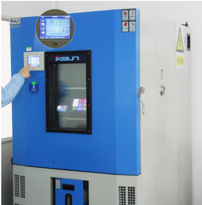
图 4-7 高低温老化测试图
